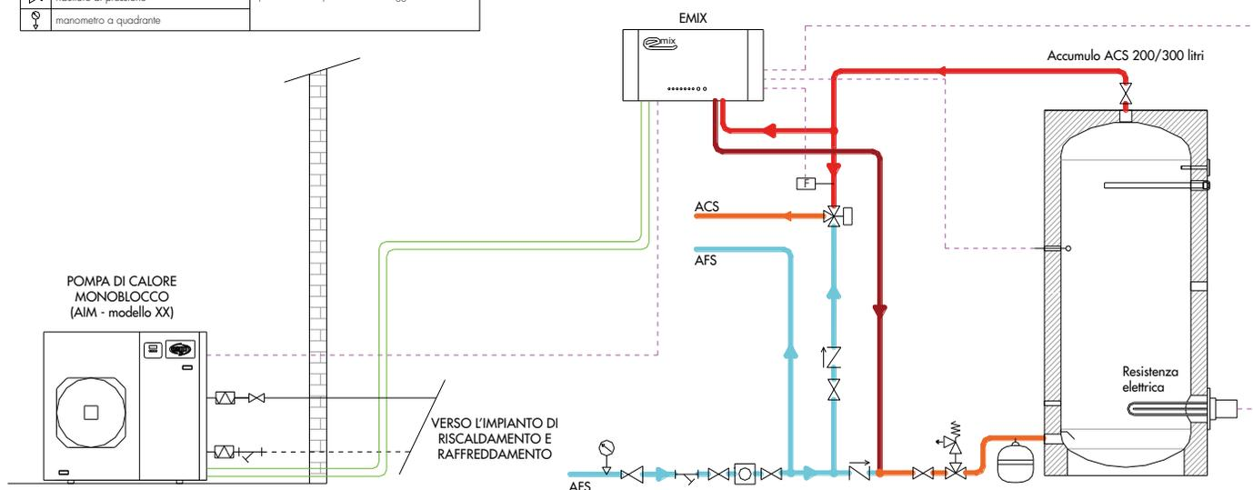
Schema con EMIX asservito ad un serbatoio di accumulo acqua calda sanitaria provvisto di resistenza elettrica idonea, gestita direttamente da EMIX. Presenza di sensore di stratificazione per il controllo della temperatura del serbatoio e di flussostato (opzionale) per l'ottimizzazione del ciclo anti-legionella. L'unità è collegata ad una pompa di calore monoblocco modello iM.
