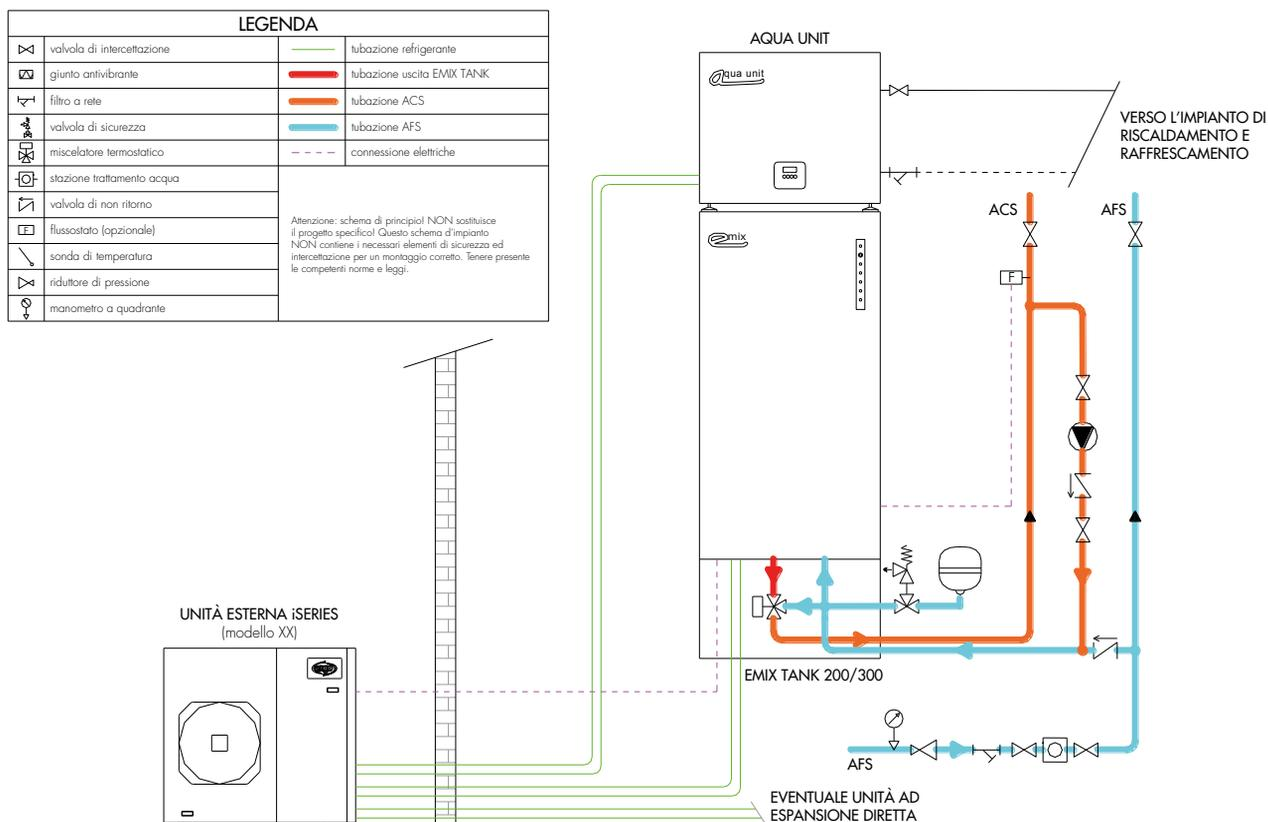
Schema con EMIX TANK collegato ad un sistema iSERIES. L'unità idronica interna AQUA UNIT trova un agevole e funzionale posizionamento sopra l'EMIX TANK consentendo la riduzione significativa degli spazi di installazione. Presenza di flussostato (opzionale) per l'ottimizzazione del ciclo anti-legionella.
