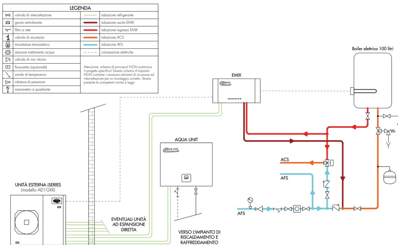
Schema con EMIX asservito ad un serbatoio di accumulo acqua calda sanitaria di piccole dimensioni, provvisto di resistenza elettrica idonea, gestita direttamente da EMIX. Il controllo della temperatura del serbatoio è effettuato da EMIX mediante prelievi periodici dell'acqua stoccata. L'unità è collegata all'unità esterna di un sistema iSERIES.
