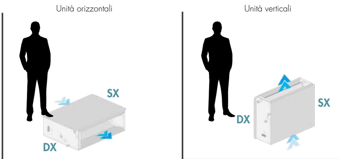
I nostri ventilconvettori hanno attacchi a sinistra come standard (se non espressamente specificato).
