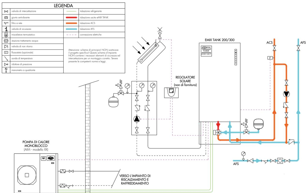
Schema con EMIX TANK collegato ad una pompa di calore monoblocco modello iM.
