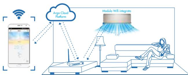
Grazie al modulo WiFi integrato è possibile controllare il funzionamento dell'unità da remoto tramite l'APP sul proprio smartphone: accendere o spegnere l'unità, selezionare modalità e temperatura desiderata, ecc., per programmare il proprio comfort in qualsiasi momento, anche quando si è fuori casa.
