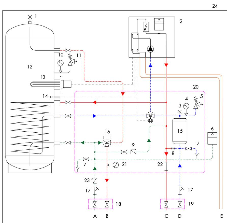
Nella soluzione semplificata l'utilizzo di un termostato ad immersione non consente la lettura diretta della temperatura dell'accumulo ACS. Inoltre la resistenza elettrica (se prevista) va gestita separatamente in quanto non è disponibile una specifica connessione con AQUA UNIT.
