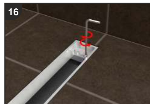
16 Regolazione in altezza della griglia con le 4 viti M6. Adjust grid height with the 4 M6 screws.
