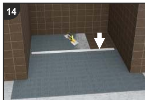
14 Rimessa della protezione in polistirolo, stesura della colla cementizio e posa delle piastrelle. Place another time polystyrene protection and spreading adhesive cement for tiles installation.
