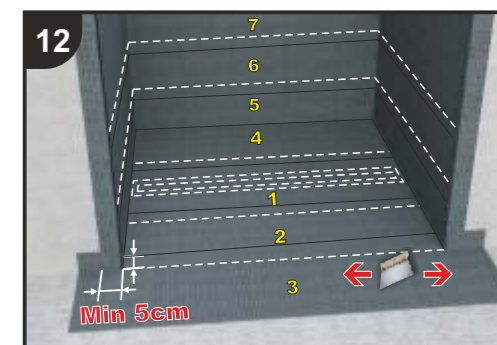
12 Stendere gli strati di guaina autoadesiva secondo il principio della posa delle tegole canadesi: partendo dal punto più in basso e procedendo con la sovrapposizione dei lembi in direzione dal basso verso l'alto. Sovrapporre almeno 5cm di lembo. Spread the layers of the sheath adhesive according to the principle of the laying of roof shingles: starting from the lowest point and proceeding with the overlap of the flaps in the direction from the bottom to the top. Overlap at least 5cm flap.
