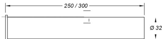
Canotto d'uscita curvo. Finitura cromata. Interamente in acciaio inox
