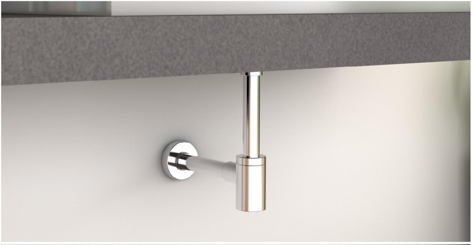
"MIGNON" sifone d'arredo in acciaio inossidabile ad altezza ridotta. Lunghezza canotti: ingresso 170 mm, uscita 300 mm
