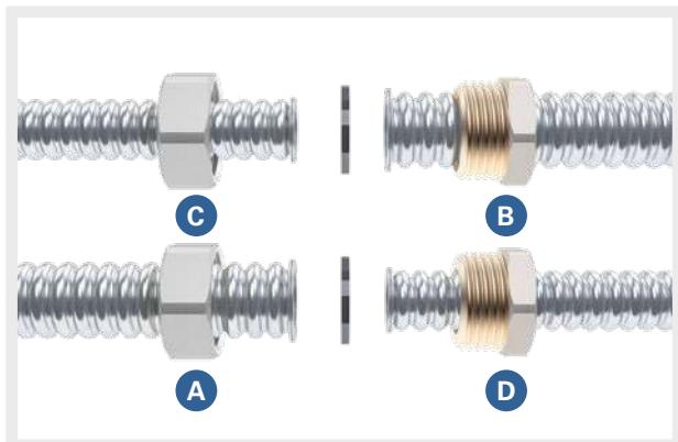
Il collegamento tra due tubi CSST con diametro diverso (ad esempio un tubo CSST DN 12 - 1/2 con un tubo CSST DN 15 - 3/4) può essere effettuato in due modi:
