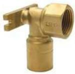
Raccordi a gomito 90° filettati femmina a pressare con staffa di fissaggio e guarnizione EPDM idonee al trasporto di acqua potabile e resistenti a temperature operative continue di 150°C, per il collegamento tra tubi CSST e terminali filettati maschio EN 10226 Rp
