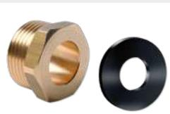
Viti semplici ridotte in ottone con filettatura maschio ISO 228 G a battuta piana e guarnizioni piane in NBR a norma EN 682 per gas
