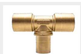
**Raccordi TEE ridotti a pressare in ottone con guarnizione in HNBR a norma EN 682 idonee al trasporto di gas, per il collegamento tra tubi CSST di diametri differenti**
