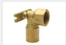
Raccordi a gomito 90° filettati femmina a pressare con staffa di fissaggio e guarnizione EPDM idonee al trasporto di acqua potabile e resistenti a temperature operative continue di 150°C, per il collegamento tra tubi CSST e terminali filettati maschio EN 10226 Rp
