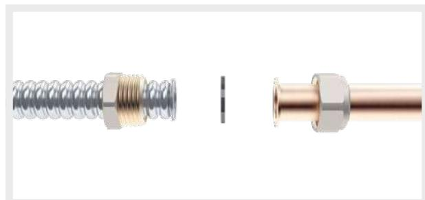
Mediante raccordo di unione M/M con una filettatura maschio ISO 228 G (a battuta piana per tenuta su guarnizione piana per tubo CSST flangiato e dado filettato femmina) e sede per ogiva in ottone (lato tubo rame).
