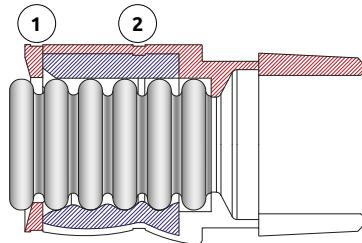
**Il 1° punto deforma l'ingresso del raccordo** dove è presente un “dente” che, ad avvenuta pressatura, blocca il tubo inserendone lo sfilamento.
