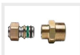
Raccordi ridotti filettati maschio in ottone ad innesto rapido con doppio o-ring, idonei al trasporto di acqua potabile e resistenti ad alte temperature operative in continuo, con filettatura maschio conica EN 10226 R, per il collegamento tra tubi CSST e terminali filettati femmina
