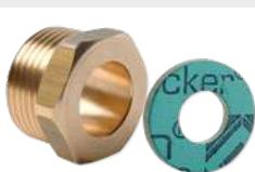
Viti semplici ridotte in ottone con filettatura maschio ISO 228 G a battuta piana e guarnizioni piane CENTELLEN WS 3820 a base di fibre aramidiche idonee al trasporto di acqua potabile e resistenti a temperature operative continue di 200°C
