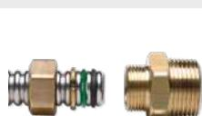
Raccordi ridotti filettati maschio in ottone ad innesto rapido con doppio o-ring, idonei al trasporto di acqua potabile e resistenti ad alte temperature operative in continuo, con filettatura maschio conica EN 10226 R, per il collegamento tra tubi CSST e terminali filettati femmina
