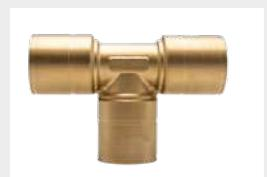
**Raccordi TEE a pressare in ottone con guarnizione in HNBR a norma EN 682 idonee al trasporto di gas, per il collegamento tra tubi CSST dello stesso diametro**
