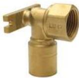
Raccordi a gomito 90° a pressare in ottone con staffa di fissaggio in ottone e guarnizione in HNBR a norma EN 682 idonee al trasporto di gas, per il collegamento tra tubi CSST e terminali filettati maschio EN 10226 Rp
