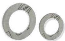
**AFM34:** Guarnizioni piane a base di fibre aramidiche idonee al trasporto di acqua potabile resistenti a temperature operative continue di 250°C (liquidi) e 200°C (vapori)
