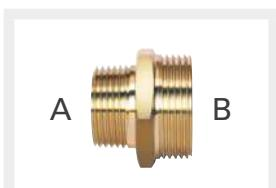
**Nipplo ridotti M/M in ottone con filettatura maschio ISO 228 G a battuta piana (B) e filettatura maschio conica EN 10226 R (A)**
