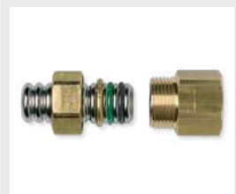
Raccordi filettati femmina in ottone ad innesto rapido con doppio o-ring, idonei al trasporto di acqua potabile e resistenti ad alte temperature operative in continuo, con filettatura femmina conica EN 10226 Rp o parallela ISO 228 G, per il collegamento tra tubi CSST e terminali filettati maschio
