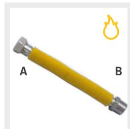
**TEG - Tubi flessibili estensibili M/F a norma UNI 11353 in acciaio inossidabile AISI 316L con guaina protettiva gialla per allacciamento di apparecchi a gas ad uso domestico e similare**
