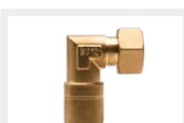
**Raccordi a gomito 90° a pressare con girello in ottone con guarnizione in HNBR a norma EN 682 idonee al trasporto di gas, per il collegamento tra tubi CSST e terminali filettati maschio a sede piana ISO 228 G**
