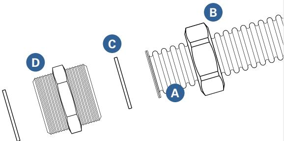
Utilizzando i raccordi con tenuta mediante guarnizione piana il tubo CSST deve essere preventivamente flangiato (“cartellato”) utilizzando gli attrezzi manuali, semi-automatici o automatici forniti da Eurotis:
