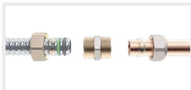
Mediante raccordo di unione M/M con tenuta su o-ring (lato tubo PLT-CSST) e sede per tenuta con ogiva in ottone (lato tubo rame).
