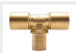
Raccordi TEE ridotti a pressare in ottone con guarnizioni in EPDM idonee al trasporto di acqua potabile e resistenti a temperature operative continue di 150°C, per il collegamento tra tubi CSST di diametri differenti
