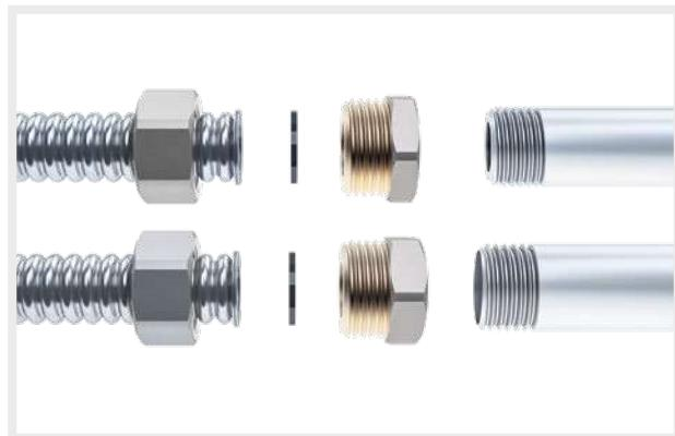
Mediante niple M/F con una filettatura ISO 228 G (a battuta piana per tenuta su guarnizione piana per tubo CSST flangiato e dado filettato femmina) e filettatura EN 10226 Rp con mantenimento o variazione del diametro utile di passaggio del fluido.
