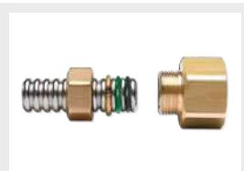
Raccordi ridotti M/F in ottone ad innesto rapido con doppio o-ring, idonei al trasporto di acqua potabile e resistenti ad alte temperature operative continue, con filettatura femmina EN 10226 Rp, per il collegamento tra tubi CSST e terminali filettati maschio
