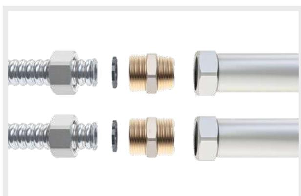
Mediane niple M/M con una filettatura maschio ISO 228 G (a battuta piana per tenuta su guarnizione piana per tubo CSST flangiato e dado filettato femmina) ed una filettatura EN 10226 R o ISO 228 G con mantenimento o variazione del diametro utile di passaggio del fluido.
