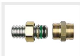
Raccordi filettati M in ottone ad innesto rapido con doppio o-ring, idonei al trasporto di acqua potabile e resistenti ad alte temperature operative in continuo, con filettatura maschio conica EN 10226 R o parallela ISO 228 G, per il collegamento tra tubi CSST e terminali filettati femmina
