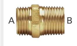
Nipplo M/M in ottone con filettatura maschio ISO 228 G a battuta piana (A) e filettatura maschio conica EN 10226 R (B)
