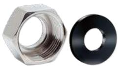
Dadi ridotti in ottone nichelato a sede speciale con filettatura femmina ISO 228 G a battuta piana e guarnizioni piane in NBR a norma EN 682 per gas
