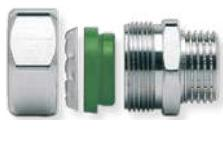
Raccordi filettati maschio in ottone nichelato ad innesto rapido, resistenti a temperature operative continue di 150°C, con filettatura maschio ISO 228 G, per il collegamento tra tubi CSST e terminali filettati femmina
