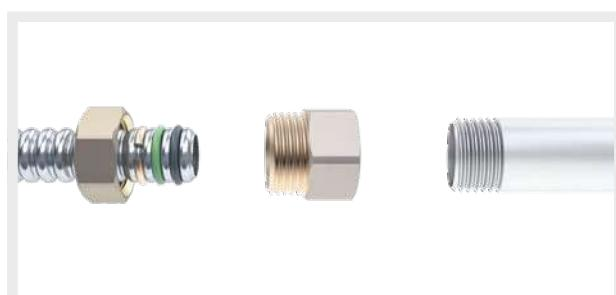
Mediante raccordo di unione ridotto M/F con tenuta su o-ring (lato tubo CSST) con estremità filettata femmina EN 10226 Rp.
