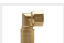
**Raccordi a gomito 90° filettati femmina a pressare in ottone con guarnizione EPDM idonee al trasporto di acqua potabile e resistenti a temperature operative continue di 150°C, per il collegamento tra tubi CSST e terminali filettati maschio EN 10226 Rp**
