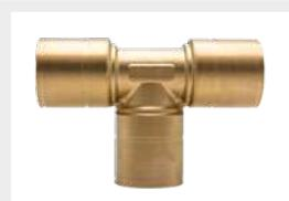
Raccordi TEE a pressare in ottone con guarnizioni in EPDM idonee al trasporto di acqua potabile e resistenti a temperature operative continue di 150°C, per il collegamento tra tubi CSST dello stesso diametro
