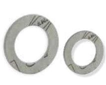
**AFM34:** Guarnizioni piane a base di fibre aramidiche idonee al trasporto di acqua potabile resistenti a temperature operative continue di 250°C (liquidi) e 200°C (vapori)
