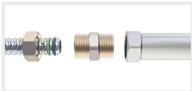
Mediante raccordo di unione M/M con tenuta su o-ring (lato tubo CSST) e con l'altra estremità filettata maschio ISO 228 G. Through a M/M connection fitting with tightness on o-ring (CSST tube side) and the other end with ISO 228 G male thread.
