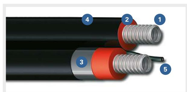
1. Tubazioni corrugate formabili CSST in acciaio inossidabile AISI 304 dello spessore di 0,3 mm (resistenza alla pressione, durabilità e facilità di posa).
