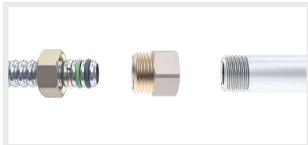
Mediante raccordo di unione M/F con tenuta su o-ring (lato tubo CSST) con estremità filettata femmina ISO 228 G.
