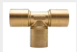
**Raccordi TEE a pressare in ottone con guarnizioni in EPDM idonee al trasporto di acqua potabile e resistenti a temperature operative continue di 150°C, per il collegamento tra tubi CSST dello stesso diametro**
