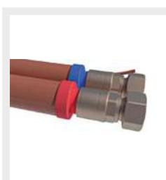
Tubi CSST binati in acciaio inossidabile AISI 304 con rivestimento isolante termico color rosso coppo in poliuretano a basso spessore e cavo multipolare per impianti solari termici. Fornitati con raccordi ePRESS già premontati da un lato.
