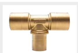
**Raccordi TEE ridotti a pressare in ottone con guarnizioni in EPDM idonee al trasporto di acqua potabile e resistenti a temperature operative continue di 150°C, per il collegamento tra tubi CSST di diametri differenti**
