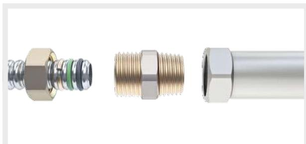
Mediante raccordo di unione ridotto M/M con tenuta su o-ring (lato tubo CSST) e con l'altra estremità filettata maschio EN 10226 R. Through a M/M reduced connection fitting with tightness on o-ring (CSST tube side) and the other end with EN 10226 R male taper thread.
