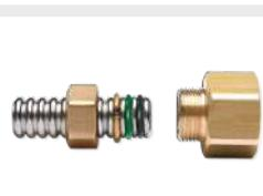
Raccordi ridotti M/F in ottone ad innesto rapido con doppio o-ring, idonei al trasporto di acqua potabile e resistenti ad alte temperature operative continue, con filettatura femmina EN 10226 Rp, per il collegamento tra tubi CSST e terminali filettati maschio
