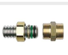
Raccordi filettati M in ottone ad innesto rapido con doppio o-ring, idonei al trasporto di acqua potabile e resistenti ad alte temperature operative in continuo, con filettatura maschio conica EN 10226 R o parallela ISO 228 G, per il collegamento tra tubi CSST e terminali filettati femmina
