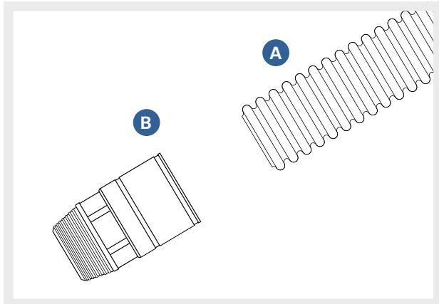
Utilizzando il sistema a pressare ePRESS la giunzione dei raccordi con i tubi CSST avviene in modo semplice, rapido e sicuro. Il risultato dell'operazione è una giunzione tubo/raccordo definitiva in quanto non è possibile separare gli elementi ritornando alla condizione originaria.
