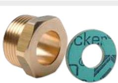
Viti semplici ridotte in ottone con filettatura maschio ISO 228 G a battuta piana e guarnizioni piane CENTELLEN WS 3820 a base di fibre aramidiche idonee al trasporto di acqua potabile e resistenti a temperature operative continue di 200°C
