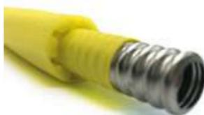
Eurotis propone la propria gamma di tubazioni CSST per impianti gas già inserite in apposita guaina di colore giallo con particolare conformazione denominata "stellare". Questa tipologia di guaina protegge il tubo, lo mantiene centrato e impedisce eventuali infiltrazioni di gas nelle cavità della parete.
