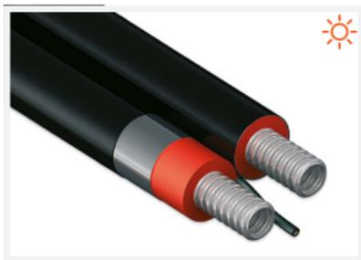
La linea SOLARTHINPOWER è composta da tubazioni corrugate formabili CSST in acciaio inossidabile AISI 304 dello spessore di 0,3 mm preisolate con poliuretano espanso flessibile di speciale formulazione che la rende utilizzabile per temperature in continuo fino a 150°C.
