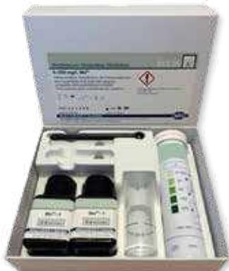
Set completo per la misurazione della diluizione dei liquidi protettivi **WPS32** (cod.120210) e **WPS 62** (cod.120211) e del liquido protettivo e di mantenimento **WPS 16** ( cod.120212).
