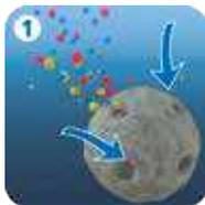
1. Attrae le molecole di carbonato di calcio (CaCO<sub>3</sub>) disciolte all'interno di specifiche cavità.
