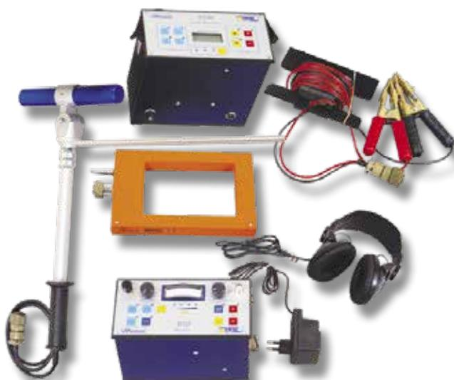
Strumento professionale completo di trasmettitore e ricevitore che consente la localizzazione e la tracciatura di sottoservizi metallici interrati quali tubazioni in ghisa, acciaio, ferro, rame, multistrato e di cavi elettrici Enel e Telecom determinandone la direzione, la verticale ed il valore di profondità.
