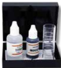
Per la misurazione della durezza dell'acqua.
