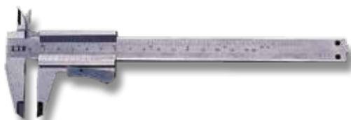
Monoblocco di alta precisione, nonio 1/20 mm, allungato, in acciaio inox cromato opaco. Scala di lettura in mm e pollici incisa in nero meccanicamente, tabella dei pesi e misure sul retro dell'asta. Bloccaggio del corsoio sull'asta mediante pulsante a molla.
