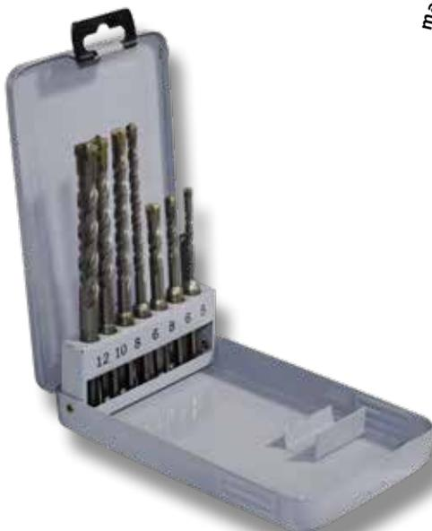
Serie di 7 punte per muratura in cassetta di metallo, con attacco SDS - PLUS, nelle seguenti misure: Ø 5 x 110 - Ø 6 x 110 - Ø 6 x 160 - Ø 8 x 110 - Ø 8 x 160 - Ø 10 x 160 - Ø 12 x 160.
