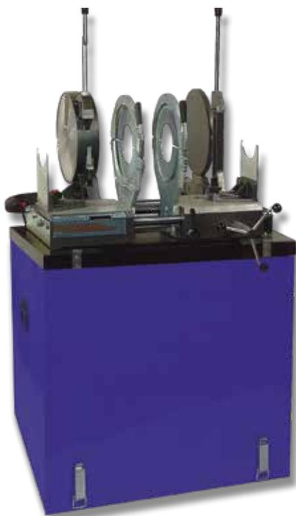
Professionale ideale per la saldatura dei tubi di scarico in PE-PP-PVDF testa/testa, curve e tee.
