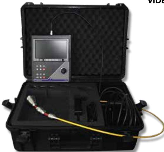
Videocamera in valigetta con sonda idonea alla ispezione delle canne fumarie, condotte, camini e fognature, le funzioni della testata sono comandate dal joystick posizionato sulla consolle alimentata a batteria.
