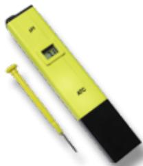
Strumento semplice da utilizzare per la misurazione del pH di una soluzione.
