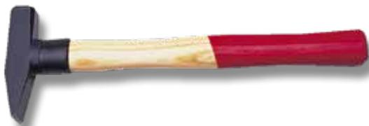
Con collare salvamanico di sicurezza a norme DIN, in acciaio C45 temperato a induzione DIN 1193, levigato lateralmente, verniciato a forno, con battenti lucidati. Bussola in nylon salvamanico, manico in frassino sagomato verniciato 1/2 rosso, bloccaggio con cuneo in acciaio e resina.
