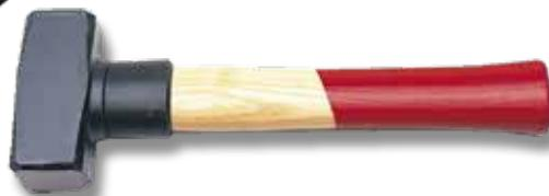
Mazzetta da muratore con collare salvamanico di sicurezza a norme DIN, in acciaio C45 temperato a induzione DIN 1193, levigata lateralmente, verniciata a forno, con battenti lucidati. Bussola in nylon salvamanico, manico in frassino sagomato verniciato 1/2 rosso, bloccaggio con cuneo in acciaio e resina.
