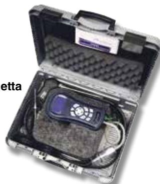
Possibilità di effettuare analisi su legna, pellet, biogas, carbone e aria propanata. Funzionano anche con stampanti ad infrarossi e vengono forniti in valigetta, carica batterie, sonda rigida con tubo flessibile da 2 m , sonda di temperatura, cavo USB, chiavetta USB, software e certificato di calibrazione.
