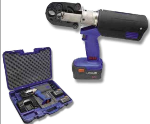
Per raccordi multistrato profilo TH, pressatura con ritorno automatico del pistone, testa girevole a 180°, contatore cicli di pressatura, led spia di funzionamento.
