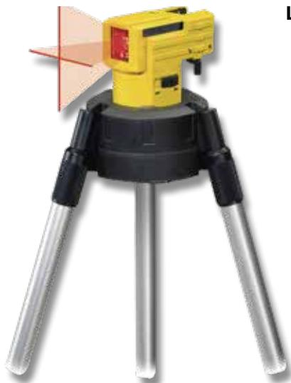
Livella laser a linee fisse incrociate con livellamento rapido a pendolo, il treppiede in dotazione (60 -100 cm) può essere trasformato in un'asta telescopica (H max 275 cm).
