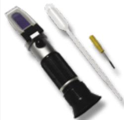
Strumento professionale indispensabile per ottenere l'indicazione della concentrazione del liquido antigelo in miscele acquose sia a base di glicole etilenico che propilenico.
