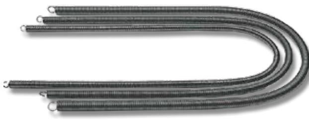
Realizzate in acciaio per la curvatura di tubi in rame ricotto. La spirale deve essere inserita nel tubo da curvare.
