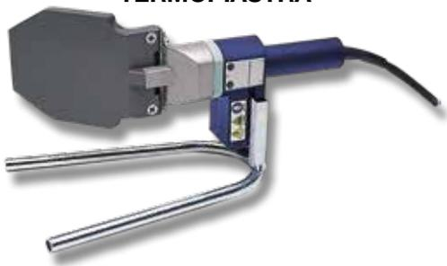
Termoelemento con rivestimento in PTFE; adatta per le saldature di testa di condotte di scarico. Progettato per effettuare le saldature di tubi appena sporgenti dalle superfici.
