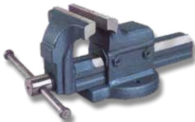
Costruita interamente in acciaio forgiato C43, doppia guida prismatica registrabile, ganasce zigrinate, temprate ad induzione e rettificate (durezza HRC 45/48).
