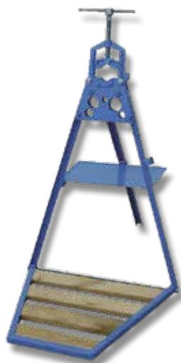
Morsa in acciaio per tubi; ganasce ribaltabili; qualità superiore, modello speciale, con doppia piastra d'acciaio e 5 fori curvatubi; pedana ribaltabile in legno; supporto portautensili.
