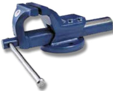
Da banco in acciaio saldato, ganasce zigrinate, temprate ad induzione e rettificata ( durezza HRC 45/48 ) lunghezza ganasce 125 mm.
