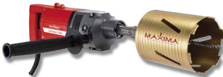
Carotatore professionale a secco adatto per fori su cemento armato, murature in mattoni, dotato di frizione meccanica ed elettronica, micro percussione.
