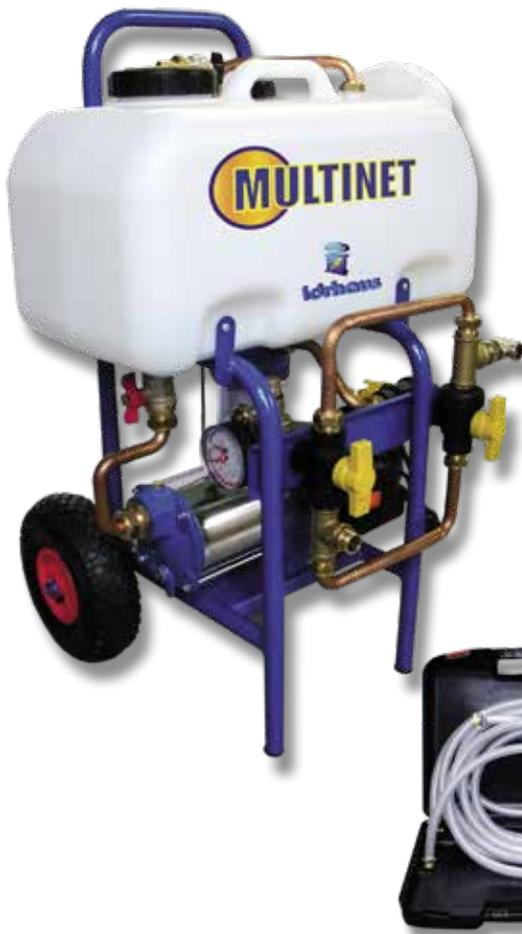
Ideale per la pulizia degli impianti termici civili e industriali per tubazioni di grosse dimensioni fino a 2" 1/2 e degli impianti a pannelli solari. Pressione variabile da 0 ÷ 6 bar mediante regolatore di pressione. Riempimento degli impianti solari e termici con disaerazione automatica. Invertitore di flusso.
