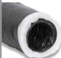
In PVC (120 micron) supportato da un filo di acciaio armonico. Il materassino isolante, in poliestere, è protetto esternamente da una manica anticondensa.
