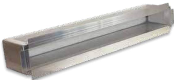
A 3 feritoie realizzato in poliuretano espanso rigido spessore 20 mm con alluminio gofrato interno ed esterno 80 micron. Completo di flangiatura portabocchetta per muratura o cartongesso.
