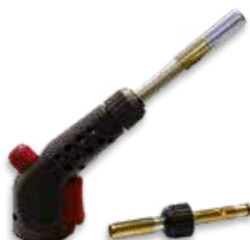
Cannello ad accensione piezo elettrica con attacco standard Europeo da 7/16" regolazione di fiamma e blocco di sicurezza, sistema antiribaltamento e pulsante di blocco per fiamma continua, dotato di due bruciatori, uno con fiamma turbo e l'altro con fiamma fine per lavori di precisione.
