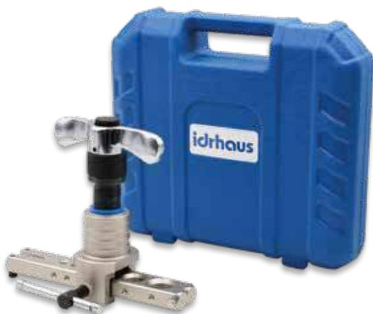
Modello universale per misure in pollici, con dispositivo autocentrante. Per colletti conici 45°. Dotata di cricco per lavori in spazi ristretti e frizione per minor attrito.
