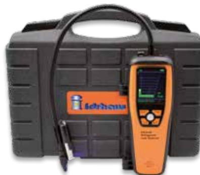
Per refrigeranti CFC - HCFC - HFC, e tutti i composti in genere contenenti alogeni (incluso R32 e 1234yf). Compatto, 6 livelli di sensibilità, segnale di perdita visivo multicolore e sonoro, funzione mute, lampada a raggi UV per la rilevazione dei gas traccianti, funzionamento del sensore in base al principio di assorbimento dello spettro infrarosso, sonda flessibile.
