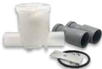
Specifico per l'installazione nelle UTA, grazie al formato molto compatto è idoneo per il drenaggio della condensa nei sistemi di climatizzazione a bassa pressione, progettato per la massima pressione di 600 Pa (6 mbar)
