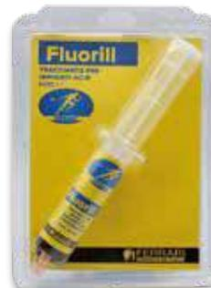
Tracciante fluorescente U/V di colore rosso per impianti di condizionamento, compatibile e totalmente miscelabile con tutti i gas refrigeranti e lubrificanti. Visibile con luce UV, visibile attraverso ghiaccio e gelo, non evapora e non lascia residui, pronto all'uso è fornito con 1 siringa da 60 ml con adattatori da 1/4" SAE e 5/16" SAE.
