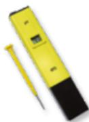
Strumento semplice da utilizzare per la misurazione del pH di una soluzione.
