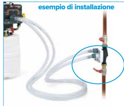
Con una pompa esterna permette di lavare gli impianti di riscaldamento senza smontare la caldaia collegando l'adattatore al posto del motore elettrico del circolatore.
