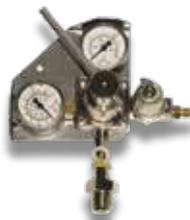
Per azoto, realizzato in acciaio inox con staffa in acciaio di protezione, completo di due manometri di lettura, raccordo di entrata per bombole azoto e raccordo di uscita 1/4" SAE con leva di regolazione a pistone.
