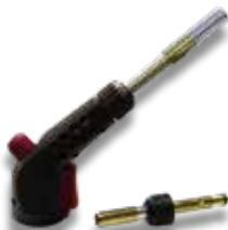
Cannello ad accensione piezo elettrica con attacco standard Europeo da 7/16" regolazione di fiamma e blocco di sicurezza, sistema antiribaltamento e pulsante di blocco per fiamma continua, dotato di due bruciatori, uno con fiamma turbo e l'altro con fiamma fine per lavori di precisione.
