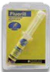
Tracciante fluorescente U/V di colore rosso per impianti di condizionamento, compatibile e totalmente miscelabile con tutti i gas refrigeranti e lubrificanti. Visibile con luce UV, visibile attraverso ghiaccio e gelo, non evapora e non lascia residui, pronto all'uso è fornito con 1 siringa da 42 ml con adattatori da 1/4" SAE e 5/16" SAE
