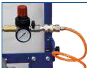
Collegamento aria con riduttore di pressione permette di miscelare aria e acqua per ottenere lavaggio flussato, spegnendo la pompa per circolazione dei liquidi permette di svuotare gli impianti con immissione di aria.
