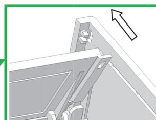
Per garantire una maggiore tenuta, durante le fasi di installazione, inserire i fermi in dotazione come in figura.
